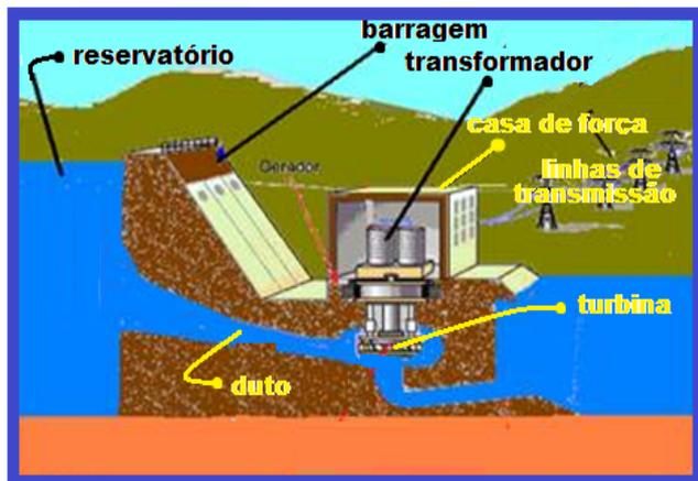
**Barragem** ► segura a água e cria um grande reservatório que é formado pelo represamento das águas do rio.
